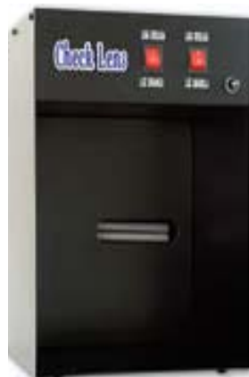
Figura 3.18 - Máquina para identificação de defeitos nos blocos
