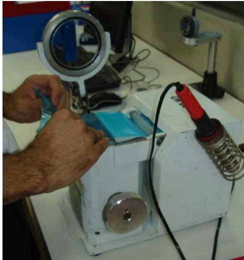
Figura 3.7 - Ilustração da colocação da fita no bloco
