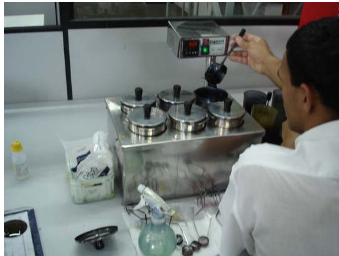
Figura 3.14 - Processo de coloração das lentes
