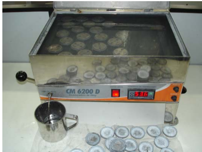
Figura 3.8 - Ilustração do processo de fusão do material
